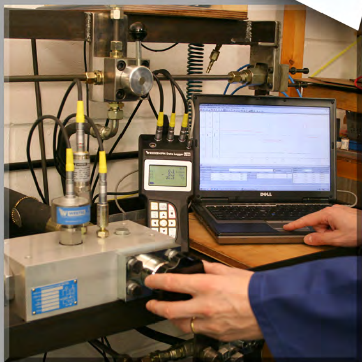
Recherche de panne sur banc d'essais avec le HPM540 connecté à un PC via USB.
