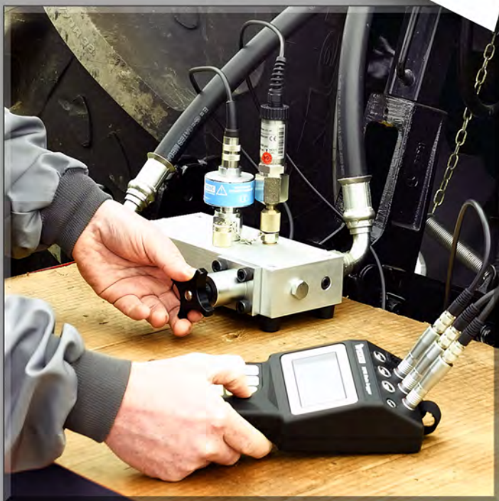
Recherche de panne avec le HPM460 sur un tracteur
