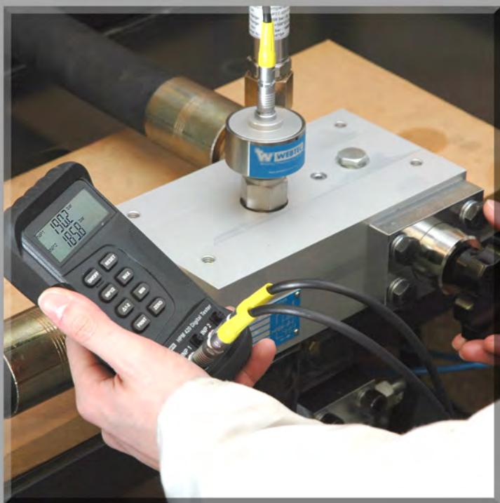
Test du débit et de la pression d'une pompe grâce au HPM420
